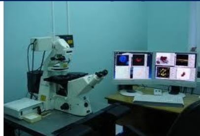
Конфокальный микроскоп ZEISS с пробоподготовкой
